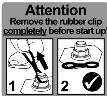
Détacher complètement la languette en caoutchouc avant la mise en service !
