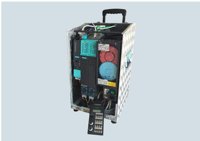
Kit de formation SINAMICS S120 avec Control Unit CU320-2
