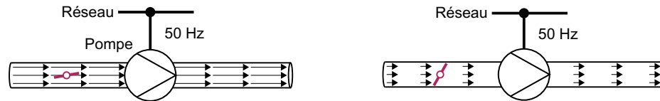
Figure 6-75 Régulation du flux avec pompe et vanne papillon dans un réseau 50 Hz
