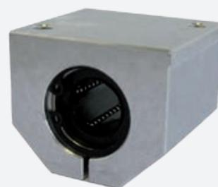
Les paliers de la série LSE...-AJ sont utilisés pour réaliser des guidages sans jeu ou pré-contraints. La vis de réglage permet de régler le jeu radial du système de guidage.
