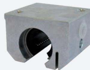
Les paliers de la série LSE...-AO sont utilisés pour réaliser des guidages sans jeu ou pré-contraints. La vis de réglage permet de régler le jeu radial du système de guidage.
