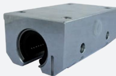
Les paliers de la série LSE...L-AO sont deux fois plus longs que les paliers de la série LSE...AO. Ils sont utilisés pour construire un système de guidage sans jeu ou pré-contraint soumis à des couples importants.
