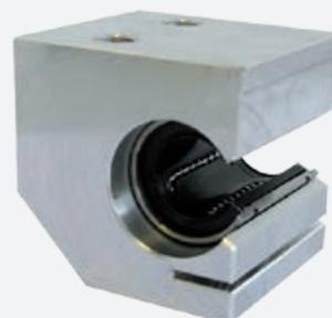
Les douilles à billes ouvertes perdent une grande partie de leur capacité de charge lorsqu'elles sont soumises à un effort radial inverse. Les paliers de la série LSE...-SOP sont conçus pour ces cas de charge particuliers.
