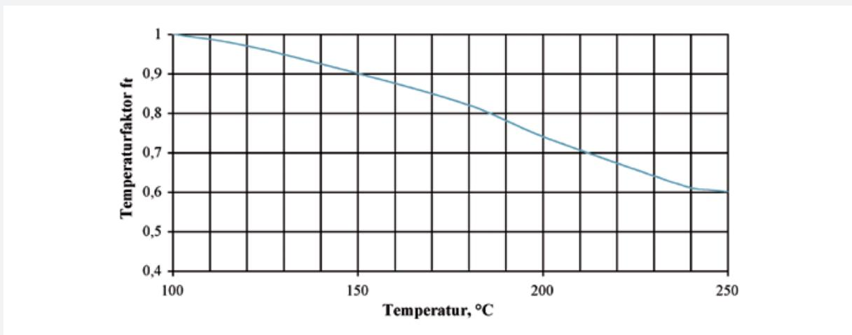
Überschreitet die Umgebungstemperatur der Kugelbuchse während des Betriebs 100°C, sind die negativen Auswirkungen hoher Temperaturen zu berücksichtigen. Darüber hinaus muss die jeweilige Kugelbuchse für hohe Temperaturbereiche geeignet sein.
