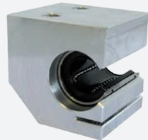
Falls bei offenen Kugelbuchsen die Belastung gegen die Öffnungsrichtung wirkt, muss mit erheblichen Tragzahlminderungen gerechnet werden. Lineareinheiten der Baureihe LSE...-SAO werden zur Aufnahme der Kräfte aus allen Richtungen ohne Tragzahlminderung eingesetzt. Mit Hilfe der Stellschraube kann das Radialspiel eingestellt werden.
