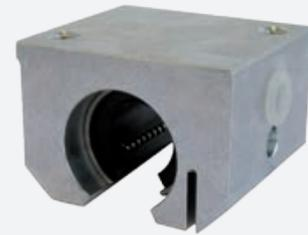
Lineareinheiten der Baureihe LSE...-AO werden bei spielfreien oder vorgespannten Führungen eingesetzt. Mit Hilfe der Stellschraube kann das Radialspiel eingestellt werden.
