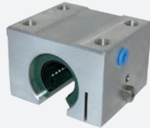
Lineareinheiten n der Baureihe LSET...-AO werden bei spielfreien oder vorgespannten Führungen eingesetzt. Mit Hilfe der Stellschraube kann das Radialspiel eingestellt werden.
