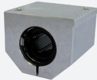
Lineareinheiten der Baureihe LSE...-AJ werden bei spielfreien oder vorgespannten Führungen eingesetzt. Mit Hilfe der Stellschraube kann das Radialspiel eingestellt werden.
