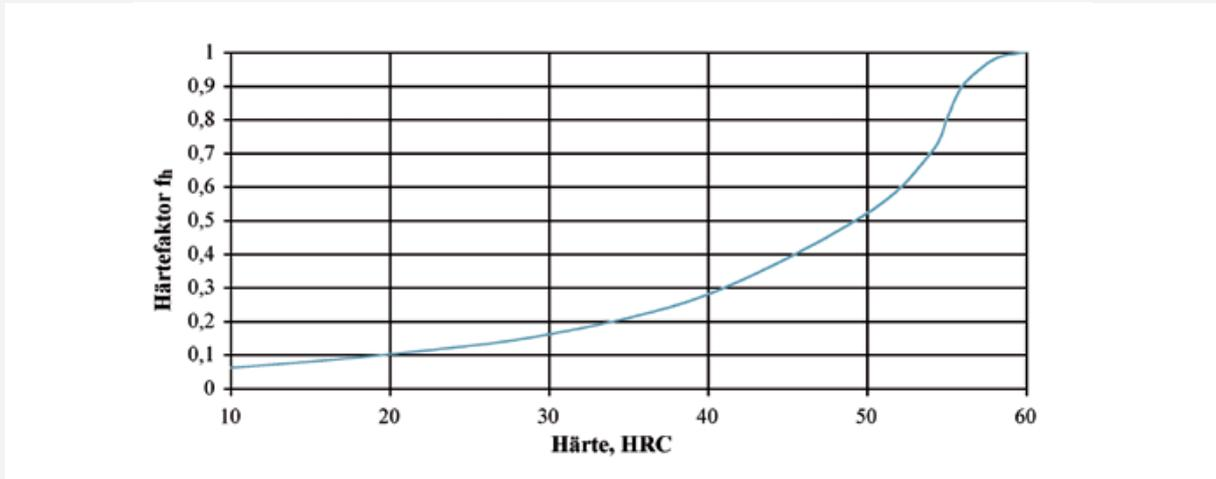
Werden Wellen mit einer niedriger Oberflächenhärte als 60 HRC verwendet, so ist ein Härtefaktor zu berücksichtigen.
