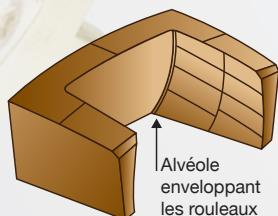
**Pollution, surcharge, échauffement, déformation du logement ou perte d'efficacité du lubrifiant sont les principales causes de défaillance. En cas de dommages initiaux, la cage massive en laiton permet une durée de vie accrue, permettant de planifier une maintenance préventive.**
